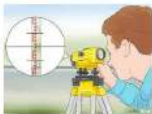
1 niveau de géomètre
